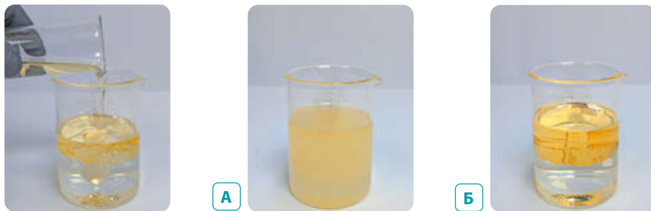
Мал. 5.2. Емульсія олії у воді не стійка: після струшування (А) через певний час рідини розшаровуються (Б)
