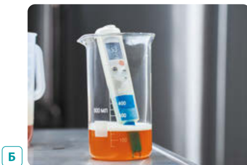
Мал. 12.4. Для вимірювання рН розчинів використовують спеціальні прилади — рН-метри: А — лабораторний (стаціонарний); Б — портативний
