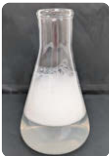
Мал. 25.5. Розчин мила: А — каламутний у жорсткій воді; Б — прозорий у м'якій воді
