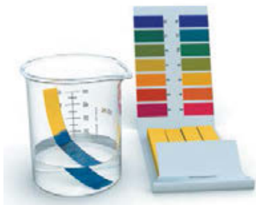
Мал. 12.3. Універсальним індикатором визначають приблизне значення рН
