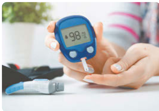
Мал. 27.5. Глюкометр — пристрій для швидкого визначення концентрації глюкози в крові
