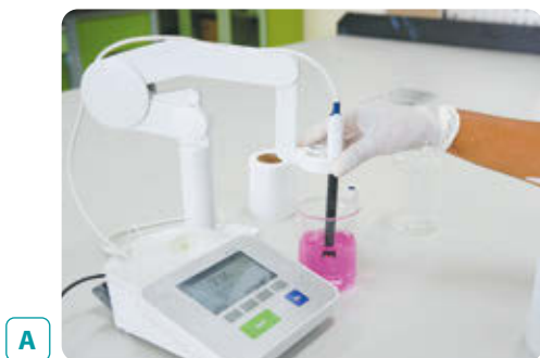
Мал. 12.4. Для вимірювання рН розчинів використовують спеціальні прилади — рН-метри: А — лабораторний (стаціонарний); Б — портативний
