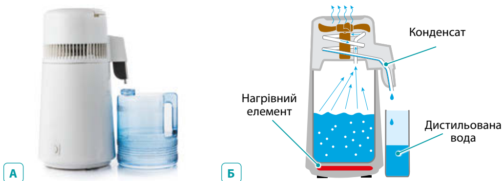
Мал. 8.3. Побутовий дистильатор — пристрій для повного очищення води:
