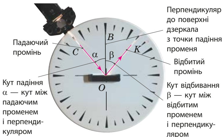
Рис. 24.2. Установлення законів відбивання світла за допомогою оптичної шайби
