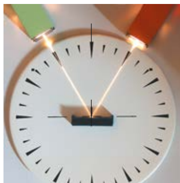
Рис. 24.4. Демонстрація оборотності світлових променів: відбитий промінь іде шляхом падаючого променя
