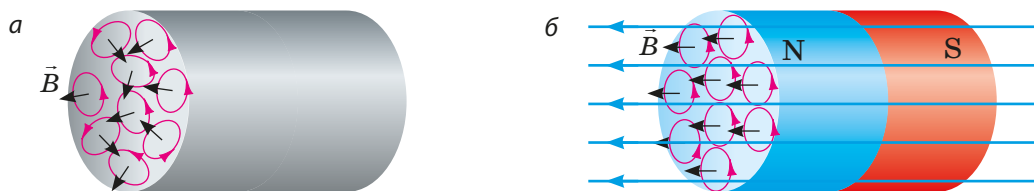
Рис. 13.1. Механізм намагнічування тіл відповідно до гіпотези Ампера: а — колові струми орієнтовані безладно, тіло не є намагніченим; б — колові струми орієнтовані в певному напрямку, тіло намагнічене
