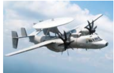
Рис. 21.5. Сучасний «летючий радар» може виявити літак супротивника на відстані 540 км
