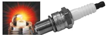
Рис. 5.4. Електрична напруга між електродами запальної свічки становить 12–15 тисяч вольтів
