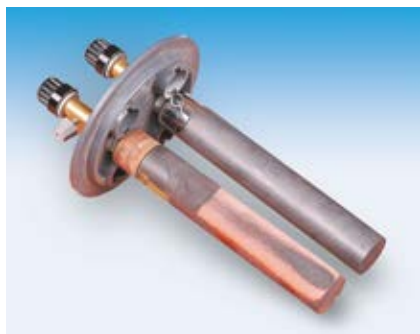
Рис. 2.5. За кілька хвилин після початку пропускання струму через розчин купрум(II) хлориду поверхню катода вкриє тонкий шар міді
