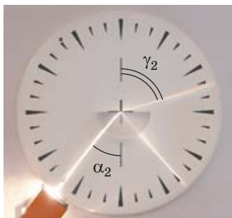
Рис. 25.2. Якщо світло падає зі скла в повітря, у разі збільшення кута падіння кут заломлення наближається до 90^\circ , а яскравість заломленого пучка зменшується
