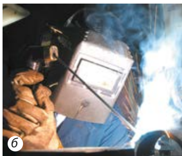
Рис. 5.8. Застосування дугового газового розряду для плавлення (а) та зварювання (б) металів
