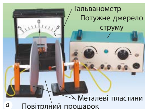
Рис. 4.1. Експеримент із вивчення провідності газів: а — за звичайних умов у повітрі майже немає вільних заряджених частинок і воно не проводить електричний струм; б — у разі внесення в повітряний прошарок запаленої спиртівки повітря стає провідником
