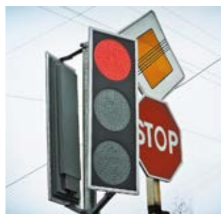
Рис. 22.3. Сигнали сучасних світлофорів добре помітні навіть тоді, коли яскраво світить сонце. У таких світлофорах працюють світлодіодні лампи
